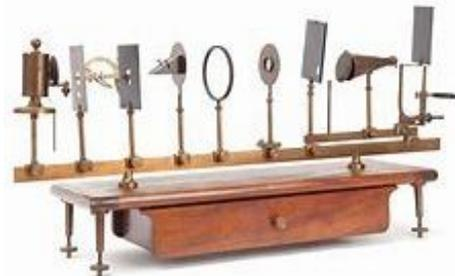
*Banco ottico progettato da Melloni per dimostrare che il "calore radiante" - "o raggianti" - (la radiazione infrarossa) si comporta allo stesso modo della radiazione luminosa.*
